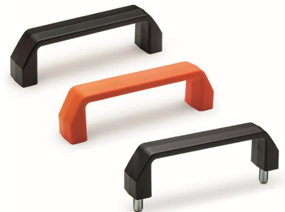
M.543 型桥式手柄，黑色或橙色，带铜毂、螺纹盲孔或镀锌钢制螺杆。
